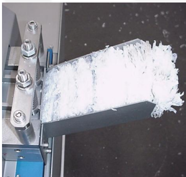
Nur noch ein Zehntel des Volumens: Polycarbonatspäne im Auswurf der KP 60
