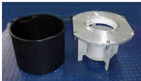
Trommeleinsatz aus Kunststoff zur Entnahme der Feststoffe
