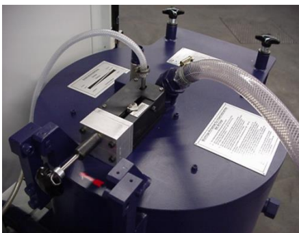
Der Drei-Phasen-Separator SMR 120 - das Herzstück der Anlage
