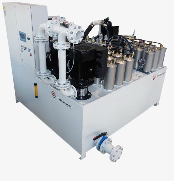
Erreichbare Reinheiten bei Turbo-Clean Systemen sind: 2-3  $\mu\text{m}$
